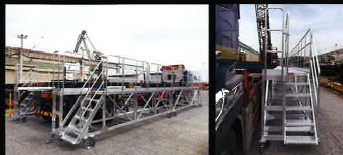
連結式玉掛作業台
