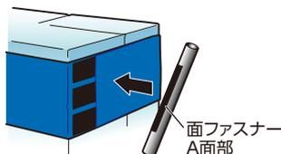
ストレッチリターンバンドを巻き取り芯に巻き取りながら荷物からはずしていきま。巻き取り芯がバンドに固定されているため、巻取りが簡単です。
